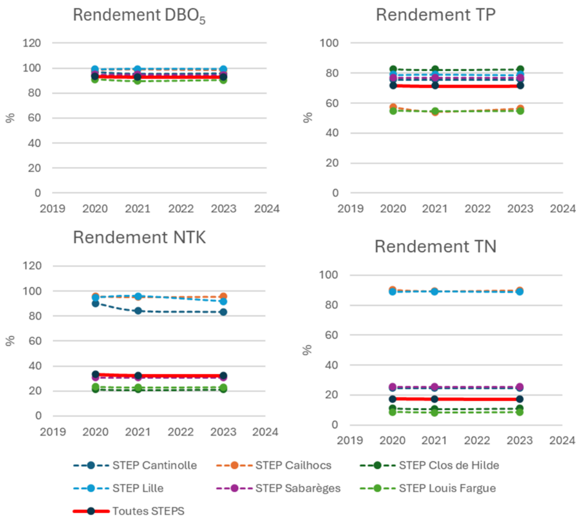
FIGURE 6. Rendement d'élimination de la matière organique (DBO 5 ), du phosphore total (TP), de l'azote total Kjeldahl (NTK : ammonium + azote organique mais sans les nitrates) et de l'azote total (TN).
